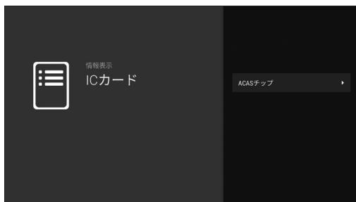
ACASチップ ACASチップの詳細情報表示とチップテストの実施画面に遷移します。
