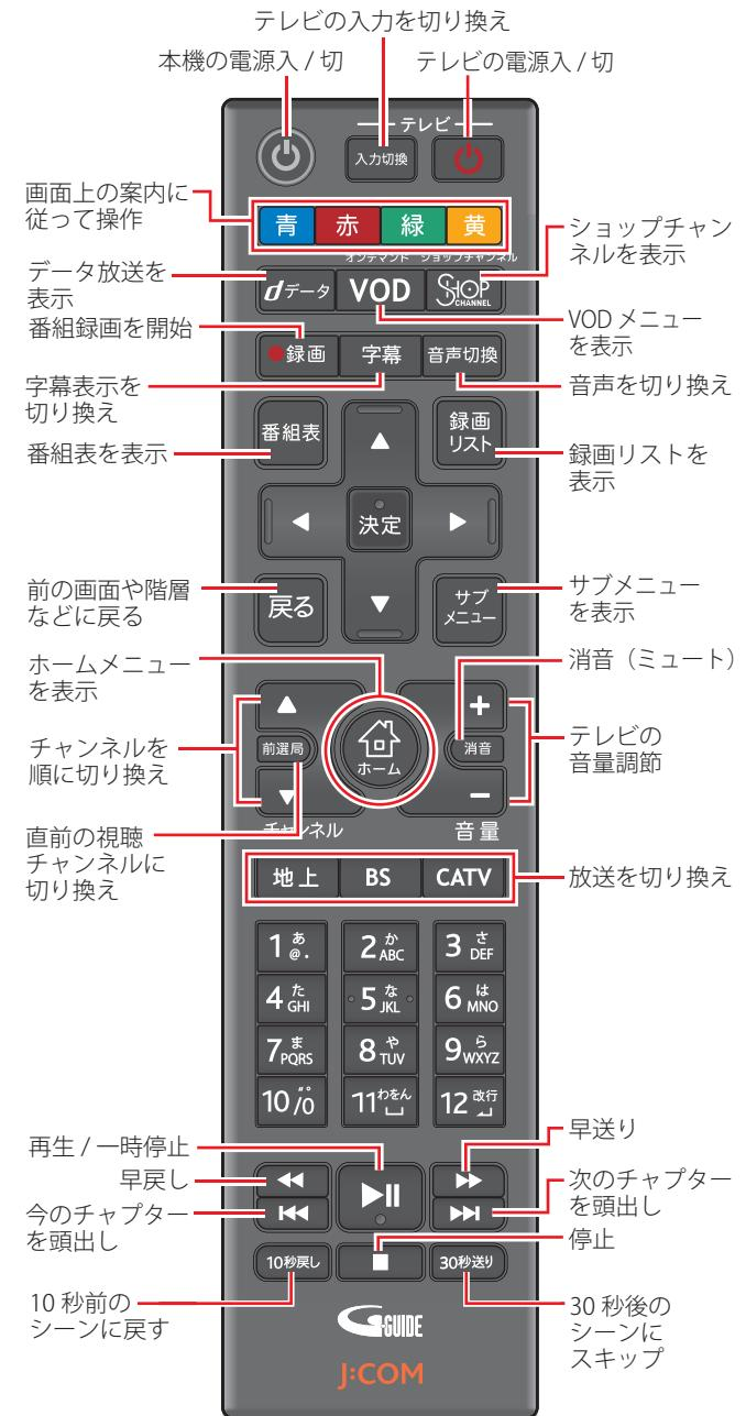
※ 本機のリモコンでテレビを操作するときは、従来のリモコンと同様に赤外線での通信となります。テレビの赤外線受光部に向けて操作してください。
